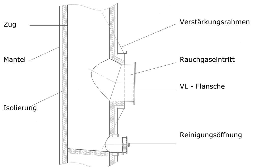
**Standard VL Flansche gemäß DIN 24154 R4 bis DN 2000 mm**
